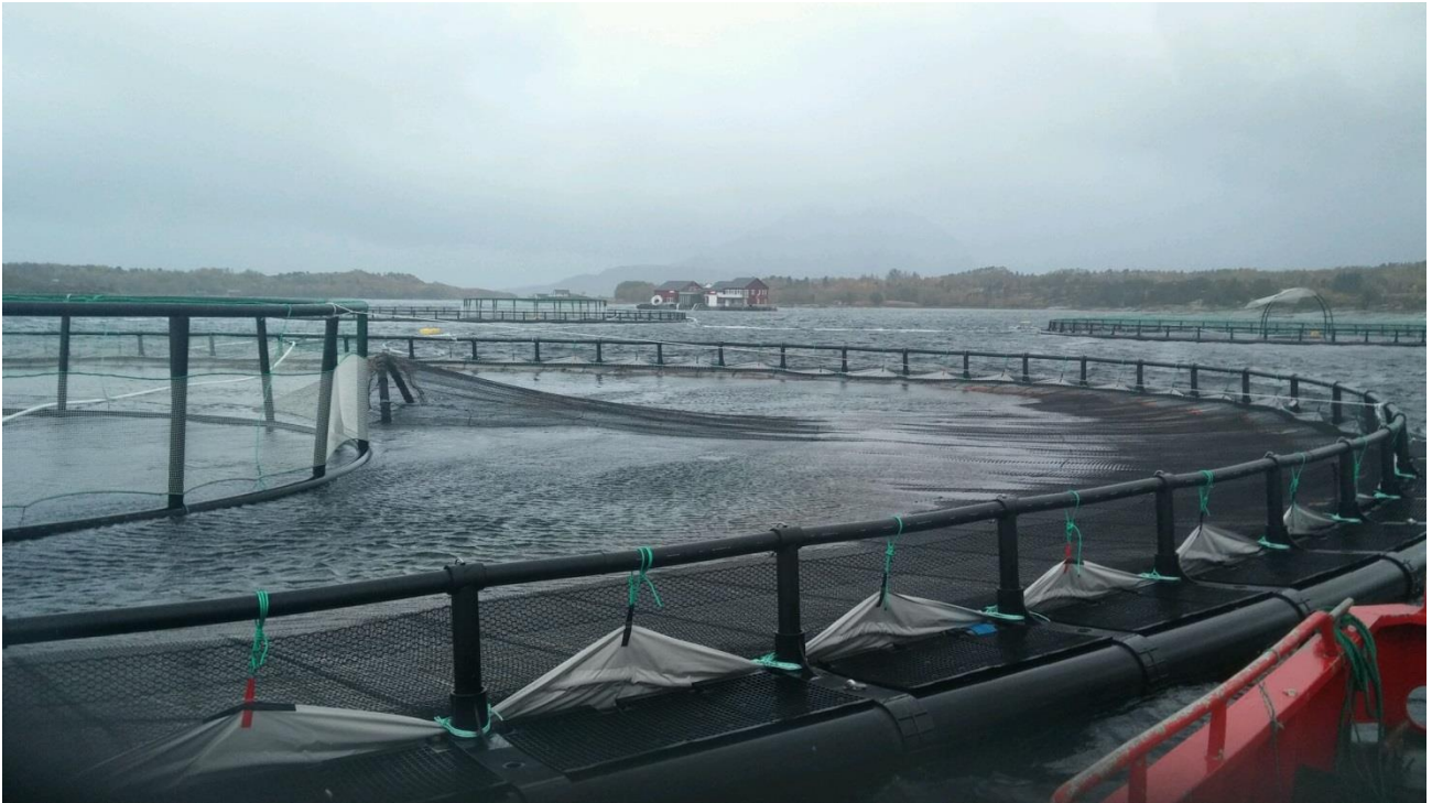
Figur 1: Eco-Net konstruksjonen tålte ikke påkjenningen fra luseskjørtene i perioder med sterk strøm.
