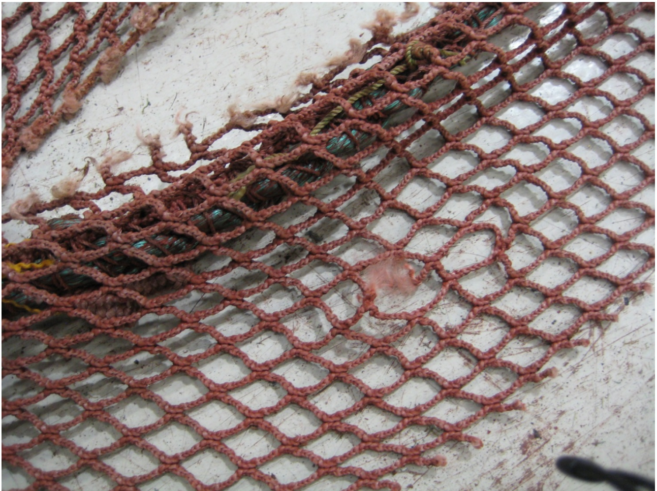
Figur 11: Bruddflatene i riftene ligner på skaden man får ved maskestyrtetst (tatt midt i bildet).
