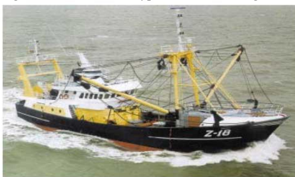
Figur 16. Bilde av en typisk bomtålrer og tålrarrangementet som fartøyet sleper.
