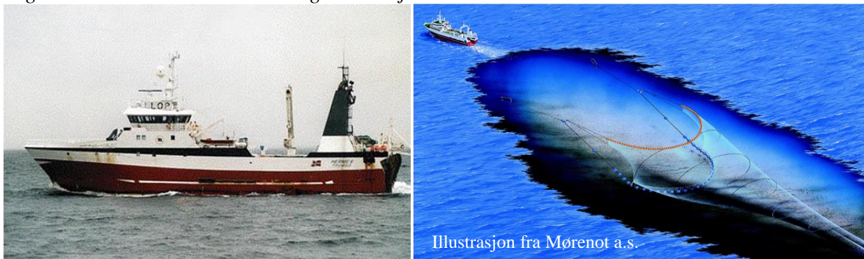
Figur 13. Bilde av en hekktråler og illustrasjon av en enkel bunntål.
